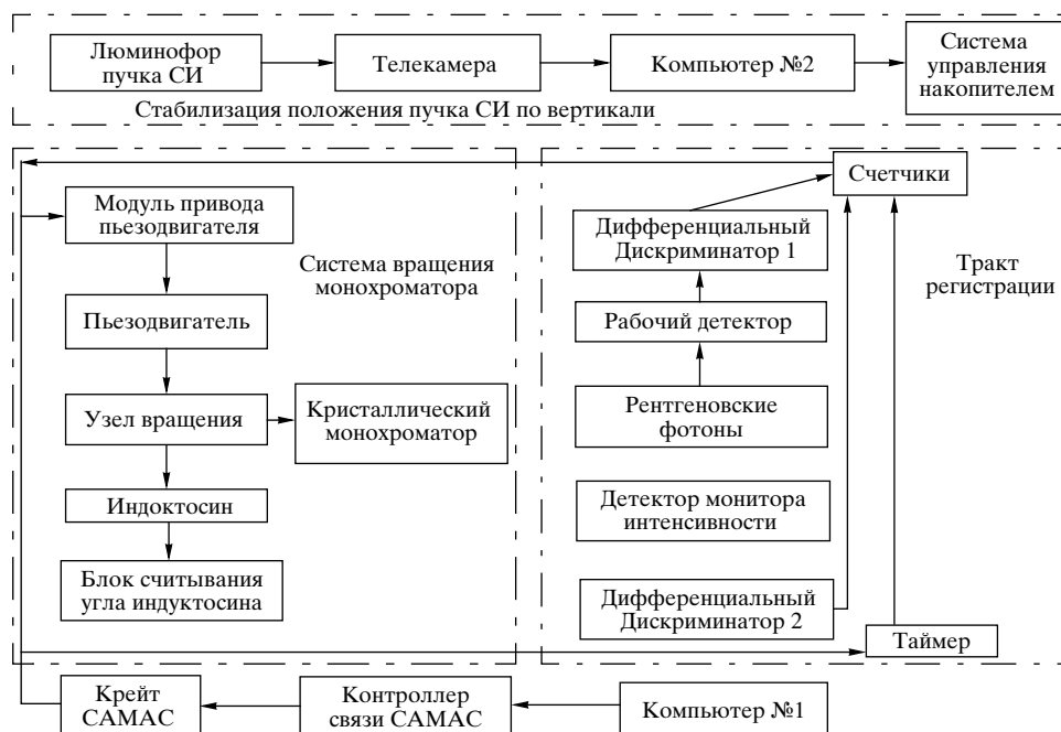
Рис. 2. Блок-схема электроники стенда для исследования EXAFS-спектров.
